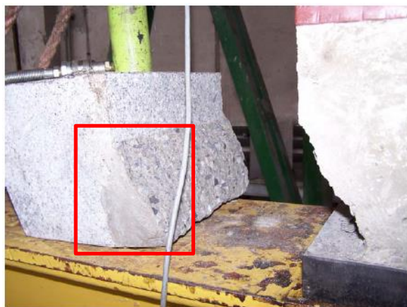
Postać zniszczenia próbki 5 (z nacięciem)
