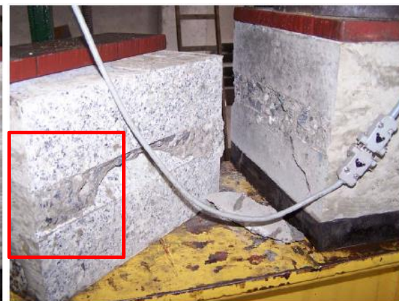
Postać zniszczenia próbki 4 (z nacięciem)
