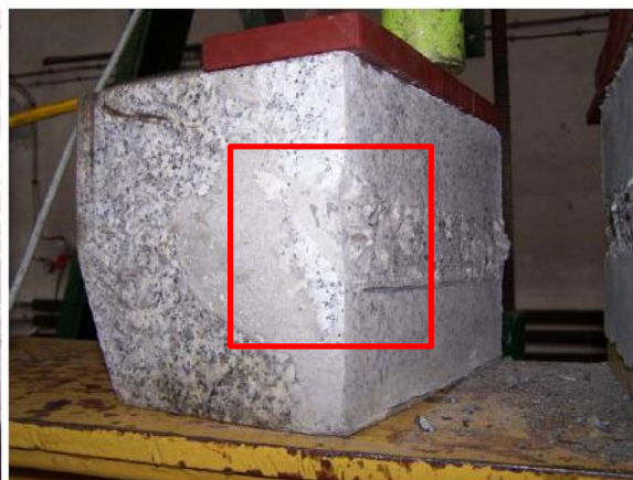
Postać zniszczenia próbki 6 (z nacięciem)
