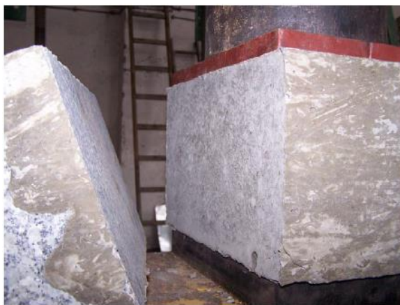
Postać zniszczenia próbek 1-3 (bez nacięcia)
