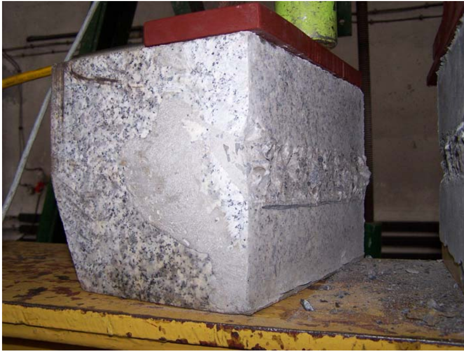
Fot. 5 Postać zniszczenia próbki 6
