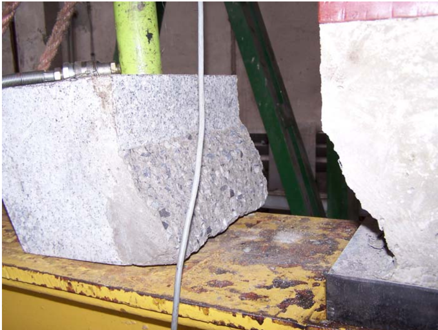
Fot. 4 Postać zniszczenia próbki 5
