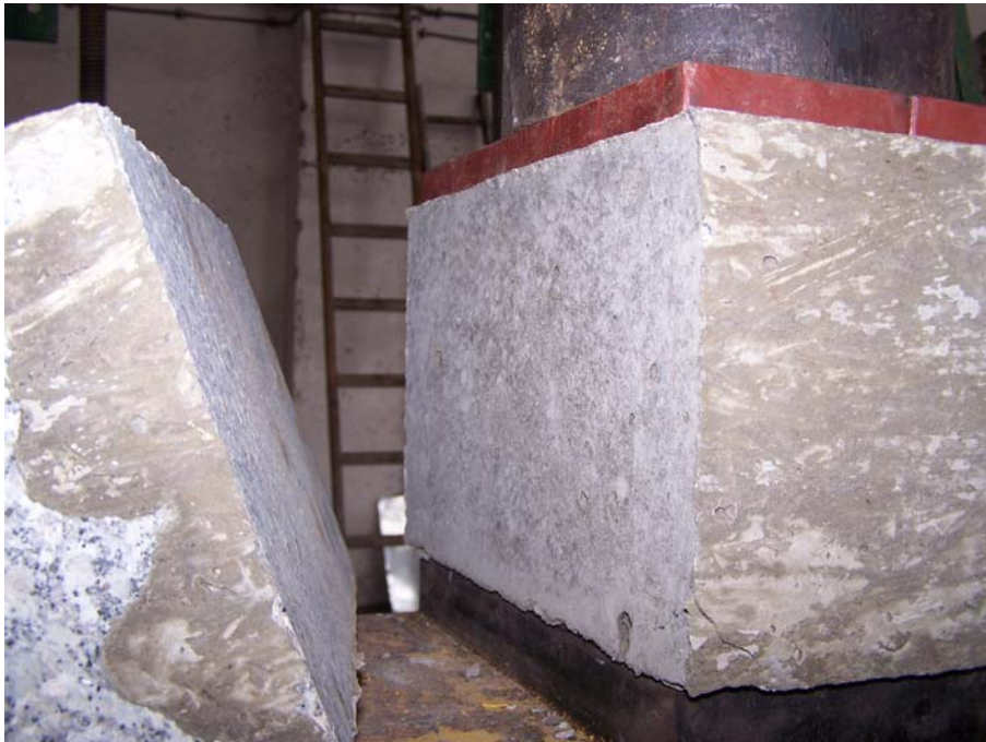
Fot. 2 Postać zniszczenia próbek od 1 do 3
