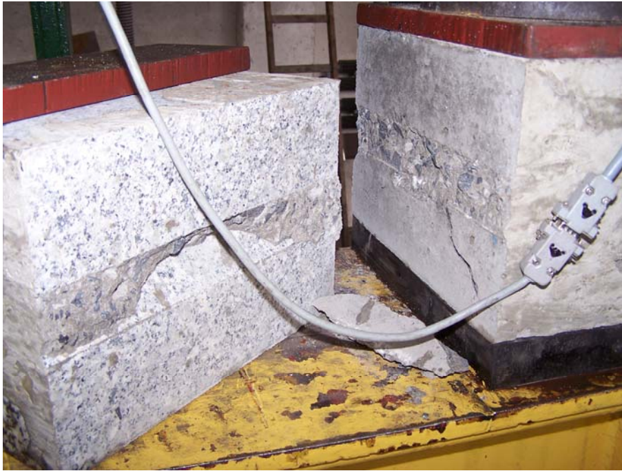
Fot. 3 Postać zniszczenia próbki 4
